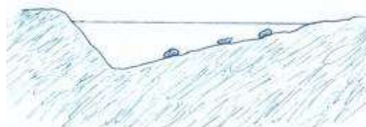
Figur 47: Principskitse for svingprofil af det nye forløb. Anlægget kan variere i forhold til det angivne på kortet.
