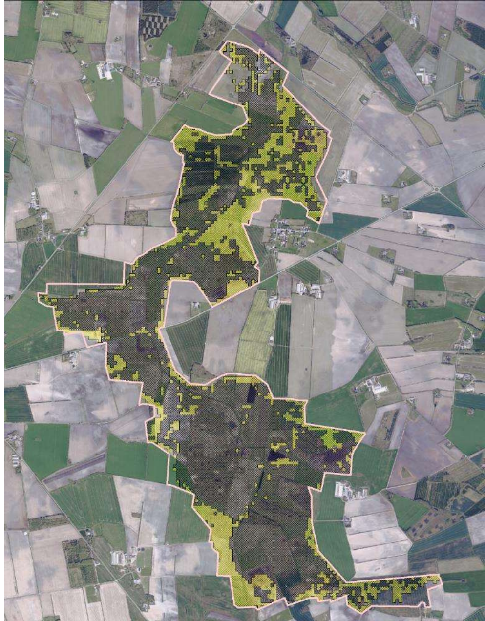
Figur 61: Angivelse af organisk indhold i henhold til tekstur2014-kort: >12 % (sort skravering), 6-12 % (gul skravering). Projektgrænse er angivet med lyserød streg.
