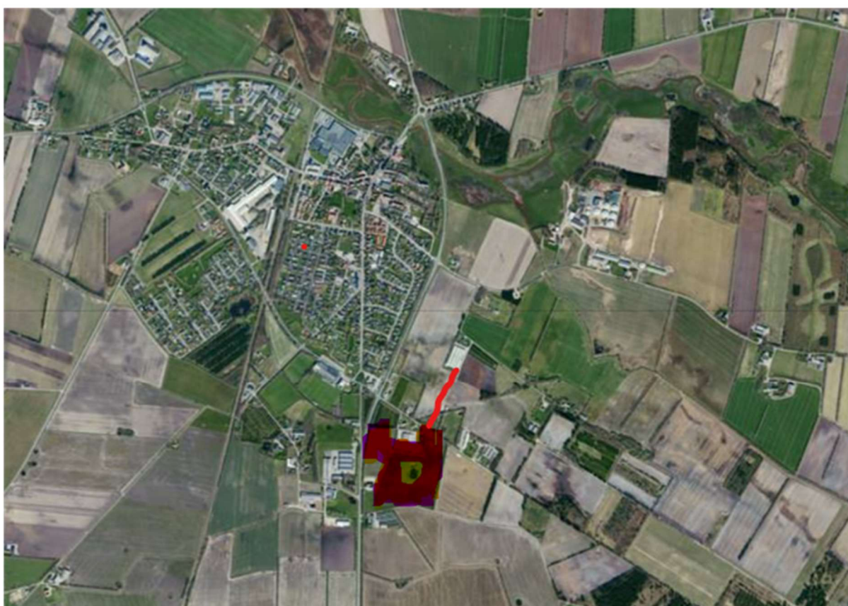
Figur 3 - Projektområdets placering øst for hovedvej A11, vist med brun markering. Rød streg viser kabeltrace til N1's 60/10-station ved Bredebro.
