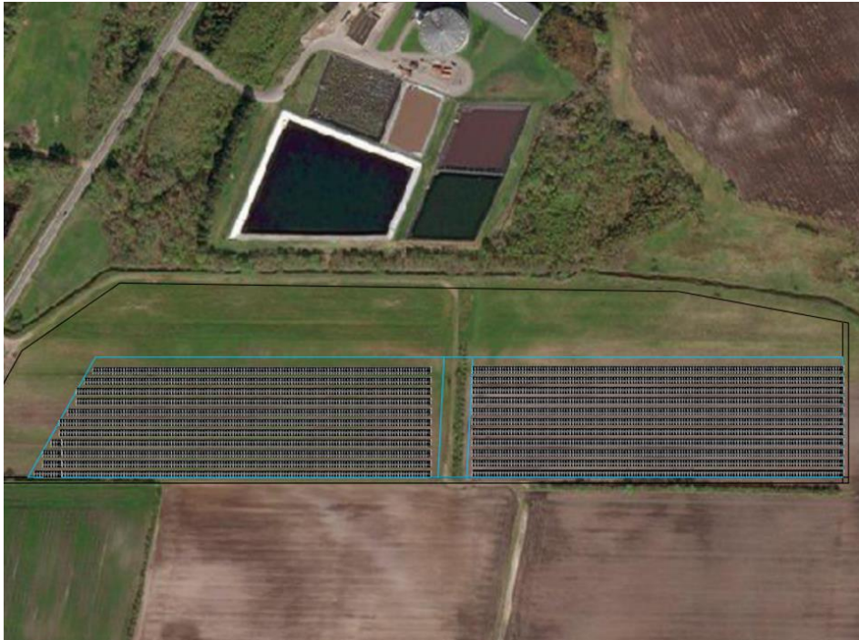
Figur 4: Solcelleanlæg på 7,3 ha med effekt på 7,88 MWp.
