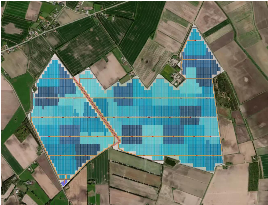
Kort 3: Foreløbigt design af VE-anlægget ved anvendelse af paneler med trackersystem.
