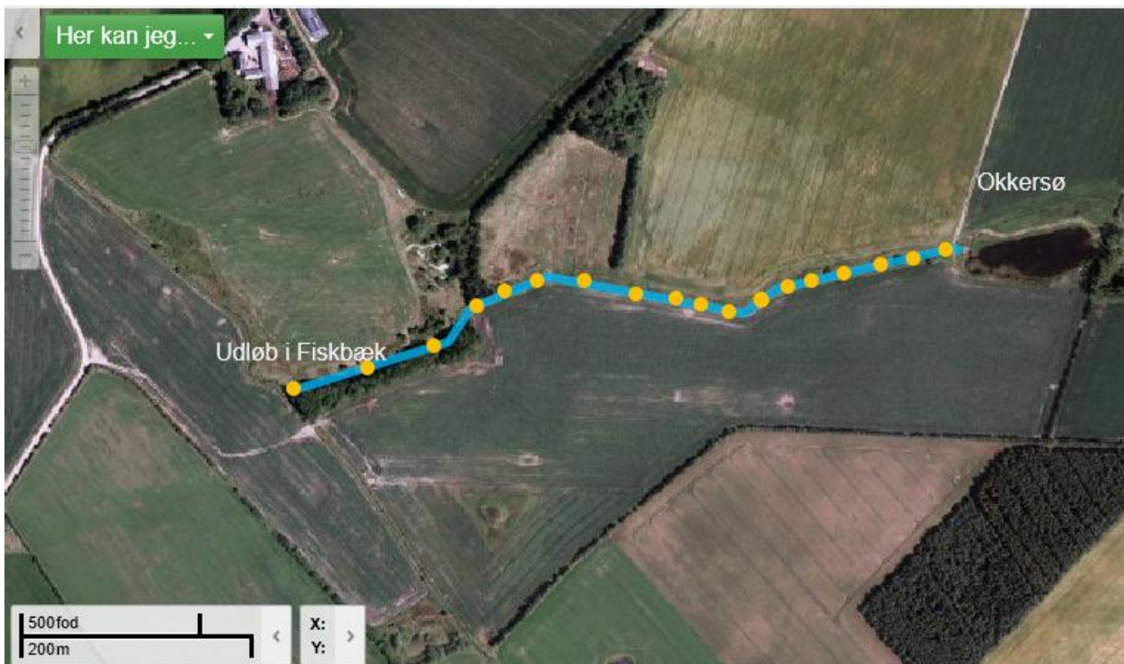
Figur 8 Illustration af placering af gydebanker (gule prikker). Der etableres ca. 17 gydebanker á en længde på 10 meter. Gydebankerne placeres med lidt længere afstand på den nedre strækning, á faldet her flader lidt ud på dele af strækningen.
